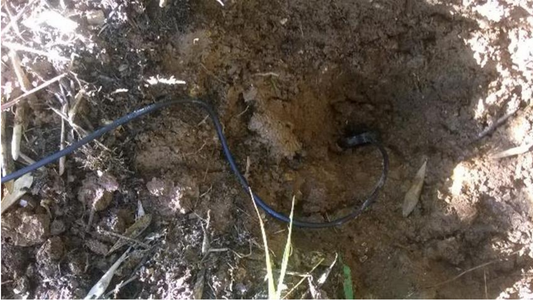
Εικόνα 14 Τοποθέτηση αισθητήρα σε βάθος 30 cm από επιφάνεια εδάφους
